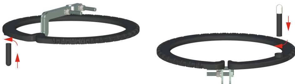
Рисунок 5 - Установка отвода и электрода-индикатора
