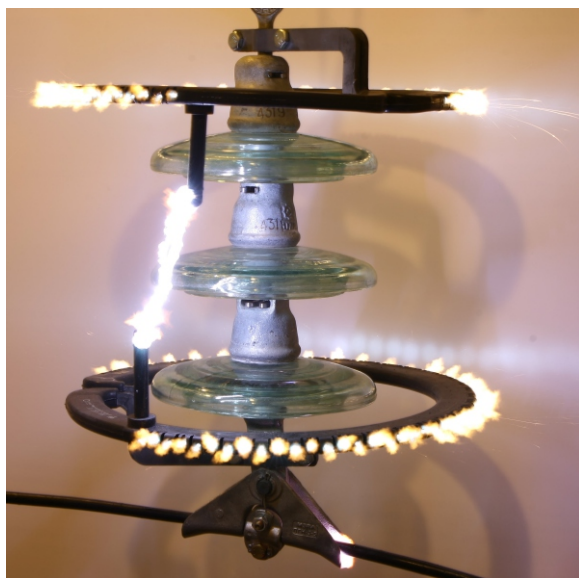
Рисунок 10 - Фотография разрядника РМКЭ-35-IV-УХЛ1 при срабатывании
